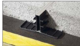
**4.5 Schlüter®-DILEX-EP** è un giunto di dilatazione per massetti adatto per fondi irregolari o massetti galleggianti. Le parti laterali sono realizzate in materiale plastico riciclato mentre le parti dilatanti, inferiore e superiore, sono in CPE morbido di colore grigio.
