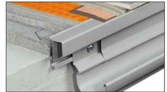
**5.10 Schlüter®-BARA-RTM** è un profilo di chiusura per balconi e terrazzi munito di gocciolatoio, per la posa a colla. Il profilo è predisposto per il fissaggio del sistema di gronda Schlüter®-BARIN. Le piastrelle possono essere chiuse con un profilo Schlüter®-RONDEC o -JOLLY oppure posate in modo che sporgano dal bordo.
