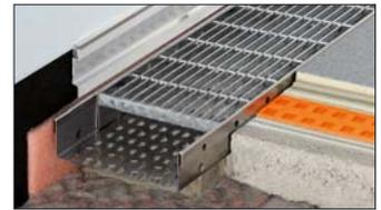
**7.4 Schlüter®-TROBA-LINE-TLR** è una canaletta drenante per balconi e terrazzi con la parte inferiore in acciaio inossidabile e la griglia superiore zincata o in acciaio inossidabili (Schlüter®-TROBA-LINE-TLRE), utilizzata per evitare il ristagno dell'acqua in corrispondenza delle soglie. Inoltre può essere utilizzata come canaletta di drenaggio da superficie.
