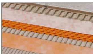
**6.2 Schlüter®-DITRA-DRAIN** è una guaina drenante a capillare passivo che consente la raccolta ed il deflusso dell'acqua di infiltrazione verso il canale di scolo, sfruttando la pendenza del sottofondo. L'applicazione a colla avviene direttamente sull'impermeabilizzazione (es. guaina KERDI) già stesa in precedenza.
