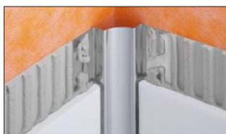
**4.15 Schlüter®-DILEX-EHK** è un giunto di dilatazione in acciaio inossidabile di forma arrotondata, adatto per raccordare rivestimenti soggetti a scarsa dilatazione e per raccordare pavimenti e rivestimenti aventi lo stesso spessore.
