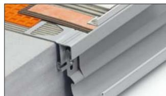
**5.9 Schlüter®-BARA-RTK** è un profilo di chiusura per balconi e terrazzi munito di gocciolatoio, da applicarsi su un massetto in pendenza per la posa a colla. Il profilo è predisposto per il fissaggio del sistema di gronda Schlüter®-BARIN. Le piastrelle possono essere chiuse con un profilo Schlüter®-RONDEC o -JOLLY oppure posate in modo che sporgano dal bordo.
