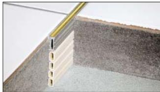
**4.2 Schlüter®-DILEX-EZ 70** è un giunto di dilatazione per massetti, costituito da una parte in PVC rigido e da una parte dilatante in PVC morbido. I segmenti possono essere rimossi in funzione dello spessore del massetto.
