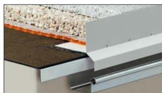
**5.20 Schlüter®-BARA-RKL** è un profilo di chiusura a forma di angolo in alluminio colorato con traforatura per lo scolo dell'acqua. E' adatto per pavimenti galleggianti di grande formato o per lastre posate su ghiaia o pietrisco.
