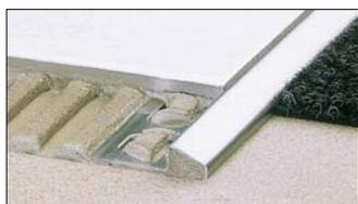
**1.2 Schlüter®-RENO-U** è un profilo adatto per raccordare pavimentazioni di diverso spessore. Tramite il distanziatore si crea uno spazio definito per la fuga tra il profilo e la piastrella.
