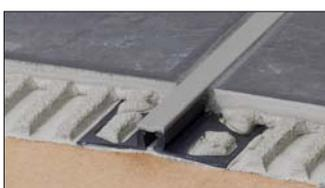
**4.6 Schlüter®-DILEX-BWB** è un giunto di dilatazione costituito da una parte in PVC rigido rigenerato e da una parte superiore larga 10 mm in CPE morbido.
