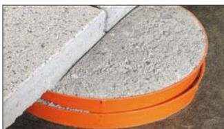
**7.3 Schlüter®-TROBA-STELZ-MR** sono anelli in materiale plastico che rendono più agevole la posa di lastre di grandi dimensioni su balconi e terrazzi. Gli anelli hanno un'altezza di 25 mm e vengono riempiti completamente con malta e posizionati nei punti di appoggio delle lastre.
