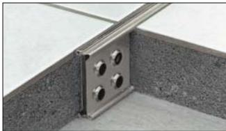
**4.17 Schlüter®-DILEX-EMP** è un giunto di dilatazione in acciaio inossidabile per massetti. I movimenti orizzontali sono assorbiti dalla parte elastica posta all'interno.
