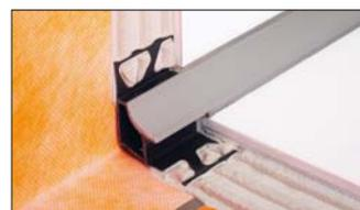
**4.11 Schlüter®-DILEX-HK** è un giunto realizzato da una parte in PVC rigido rigenerato e da una parte arrotondata in plastica morbida, adatto per raccordare il pavimento al rivestimento ed in grado di soddisfare i requisiti di igiene e di pulizia richiesti ad esempio nell'industria alimentare o nelle cucine.
