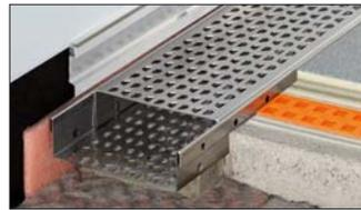
**7.4 Schlüter®-TROBA-LINE-TL** è una canaletta drenante in acciaio inossidabile per balconi e terrazzi utilizzata per evitare il ristagno dell'acqua in corrispondenza delle soglie. Inoltre può essere utilizzata come canaletta di drenaggio da superficie.
