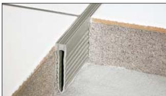
**4.4 Schlüter®-DILEX-MOP** è un giunto di dilatazione per massetti a sezione laterale dentellata, realizzato in PVC rigido riciclato e con parte dilatante in PVC morbido di colore grigio.
