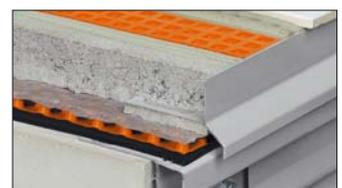
**5.4 Schlüter®-BARA-RK** è un profilo di chiusura munito di gocciolatoio, particolarmente adatto per proteggere la parte esterna del drenaggio TROBA. L'aletta di chiusura è inclinata in avanti per favorire il deflusso dell'acqua.
