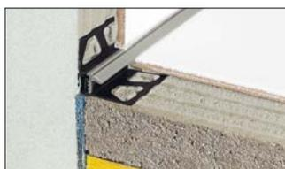
**4.14 Schlüter®-DILEX-EK** è un giunto di dilatazione perimetrale, realizzato in plastica, con una parte rigida ed una morbida collegate telescopicamente tra di loro, che non necessita di manutenzione e raccorda perfettamente il pavimento al rivestimento o al battiscopa.
