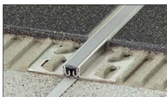
**4.8 Schlüter®-DILEX-KS** è un giunto di dilatazione in ottone, alluminio od acciaio inossidabile adatto anche a proteggere gli spigoli delle piastrelle, composto da alette di fissaggio laterali e da una parte dilatante in gomma sintetica.
