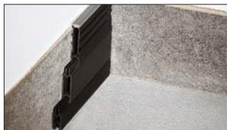
**4.3 Schlüter®-DILEX-MP / -MPV** è un giunto di dilatazione per massetti, avente una struttura in PVC rigido riciclato e una parte dilatante in CPE morbido; è dotato di prolunghe.
