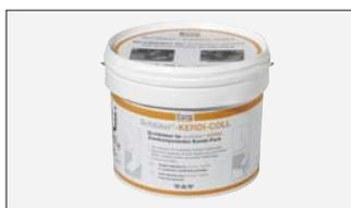
**8.4 Schlüter®-KERDI-COLL** è una colla impermeabilizzante bicomponente composta da una base acrilica liquida priva di additivi e da una polvere reagente a base cementizia. E' adatto per l'incollaggio delle fascette KERDI sulle giunzioni dell'impermeabilizzazione.
