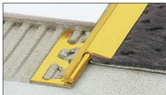
**1.7 Schlüter®-RENO-V** è un profilo con un'ala di raccordo snodabile per unire pavimentazioni di diverso spessore senza creare dislivelli. Tramite il di distanziatore si crea uno spazio definito per la fuga tra il profilo e la piastrella.
