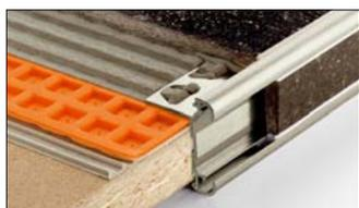
**2.8 Schlüter®-RONDEC-STEP-CT** è un profilo angolare di chiusura adatto per piani di lavoro delle cucine e dei depositi che abbiano un rivestimento ceramico. Nello spazio del profilo che rimane vuoto, può essere fissato lo stesso rivestimento utilizzato nella parte superiore o possono essere utilizzati altri elementi decorativi.
