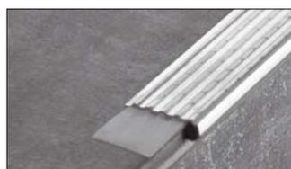
**3.3 Schlüter®-TREP-EK** è un profilo per scale in acciaio inossidabile con profilatura antiscivolo. È adatto per proteggere lo spigolo del gradino ed è realizzato in una forma esteticamente piacevole. Viene applicato su gradini con rivestimento ceramico a posa già ultimata.
